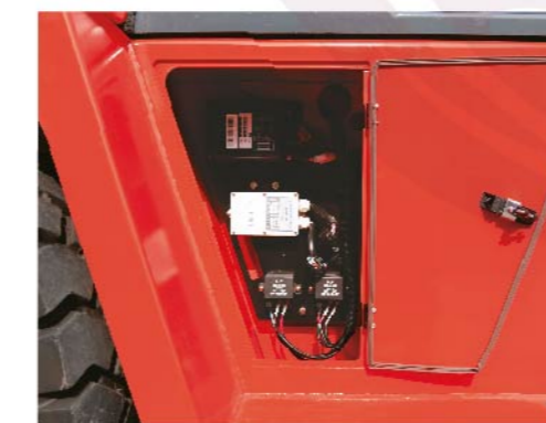
Независимый встроенный отсек электрооборудования
