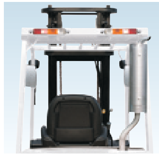
Система выпуска -- установлена на защитной крыше
