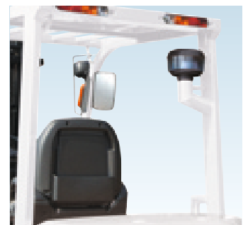
Фильтр предварительной очистки -- установлен на защитной крыше (доступно на погрузчиках с бензиновыми двигателями)
