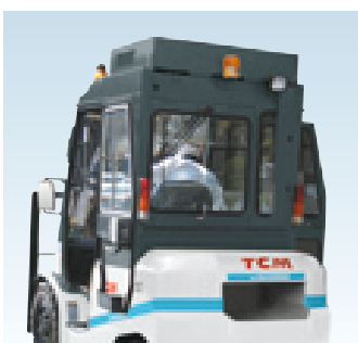
Полностью закрытая стальная кабина с кондиционером (доступно на погрузчик 23ках грузоподъемностью от 2 до 3,5 тонн)
