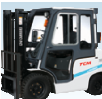
Кабина оператора с боковыми панелями (доступно на погрузчиках грузоподъемностью от 2 до 3,5 тонн)
