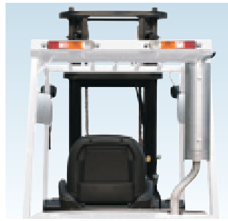
Система выпуска -- установлена на защитной крыше
