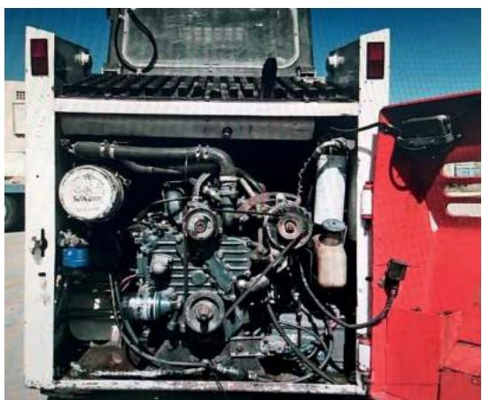
**Продольное расположение двигателя** (как у Bobcat первых поколений, о чём уже мало, кто помнит) и всех гидронасосов - дало возможность низкой компоновки всего силового модуля; низкий центр тяжести, хорошая боковая устойчивость. На фото: Bobcat прежнего поколения модель 743 с продольным расположением двигателя. Цифра «4» в нумерации моделей Bobcat ранее означала именно продольное расположение двигателя. Такой комплектацией обладали модели 443, 543, 643, 743, 843.
