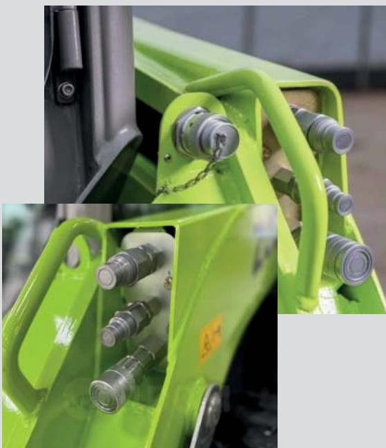
**Блок быстроразъёмных гидравлических коплеров** (гидромуфты РВД), как у Bobcat, надёжно защищён корпусом грузоподъемной стрелы. Все гидролинии (РВД) протянуты внутри грузовой стрелы, что полностью исключает их механические повреждения в процессе эксплуатации:
